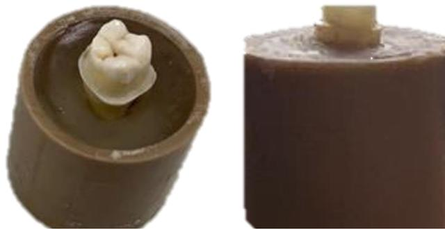
Após preparados, os dentes foram vaselinados e envolvidos com tiras de poliéster formando um anel a 2 mm do dente. Em seguida, foi acrescentada resina bisacrílica PROTEMP (3M – Sumaré, SP, Brasil) em ua e um uma porca garra 5/16 zincada foi inserida na extremidade superior com 4 mm de profundidade na resina (Figura 8).
