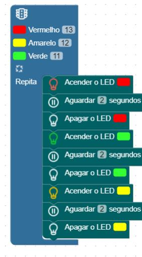
Figura 6.13: Exemplo de algoritmo montado no UpRobotics para o semáforo
