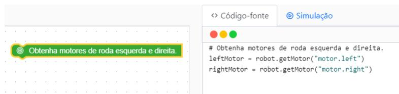
Figura E.31: Thymio II - Obstáculos: obter motores da roda esquerda e da roda direita
