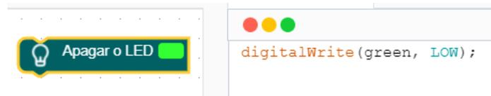
Figura E.6: Semáforo: apagar o LED verde
