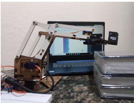
Figura 7.1: Braço robótico deixando um objeto em cima de uma pilha de livros.
