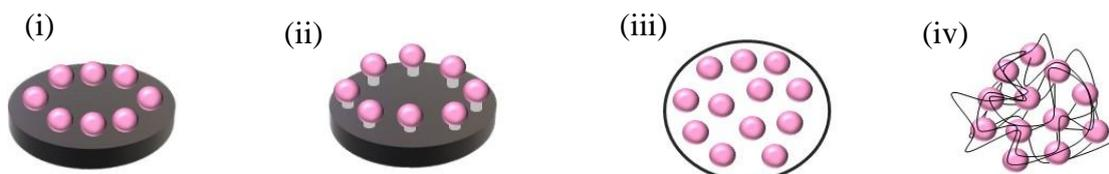
**Figura 3. 5.** Ilustração dos tipos de procedimentos de imobilização: (i) adsorção, (ii) ligação covalente, (iii) encapsulação e (iv) ligação covalente cruzada. (Próprio autor).
