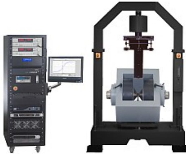
Figura 3.4: Magnetômetro da amostra vibrante do tipo Microsense Model EV7.
