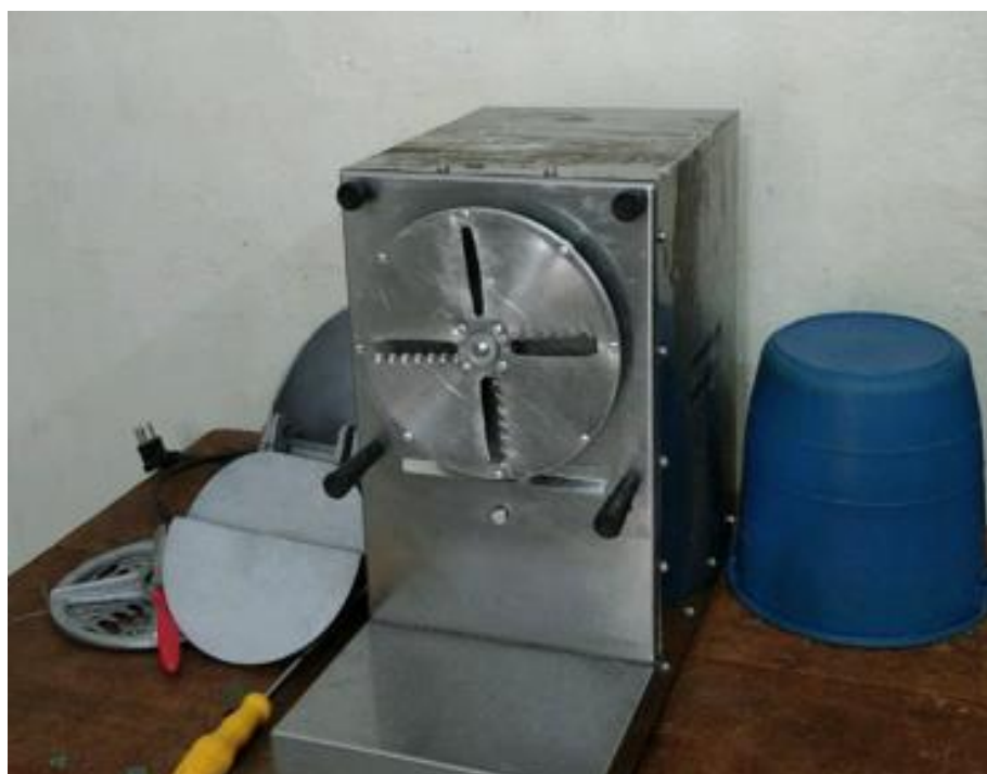
Figura 61 – Máquina adaptada para a produção de castanha triturada, farinha da castanha e castanha fatiada
