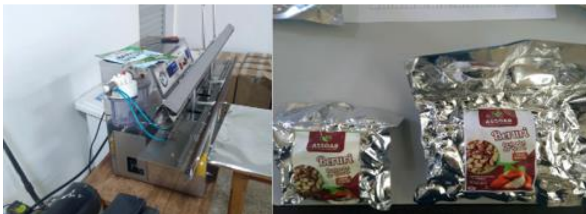
Figura 48 – Embaladora a vácuo e produto acabado embalado em embalagens de 250 e 500 gramas
