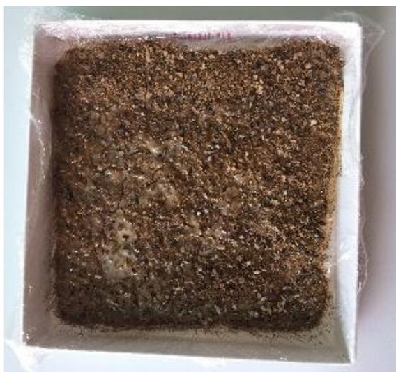
Após a inserção da mistura nos moldes os experimentos passaram por uma etapa de estabilização que durou um período de quatro dias. Os experimentos iniciaram no dia três de julho de 2018 às 15 horas e finalizados no dia sete de julho de 2018, completando um ciclo de noventa e seis horas. A retirada do experimento do molde (desmoldagem) iniciou por meio da remoção do microfilme. No experimento 1 a remoção do microfilme não apresentou dificuldade, permitindo uma eliminação do
