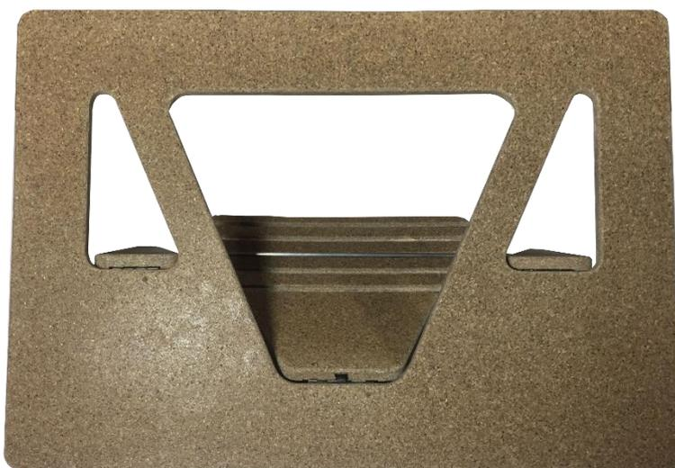
Vista posterior do protótipo com detalhes do subsistema de angulação em funcionamento (Figura 122) onde o eixo limitador de ângulo basculha de encontro as canaletas do suporte central.
