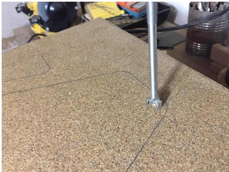
A partir dos furos realizados prossegue-se com a abertura dos rasgos no interior do objeto, de maneira que o corte fique aproximadamente 3mm distante das linhas de marcação para que estas sejam visualizadas na etapa de usinagem com tupa laminadora, procedimento esse realizado com serra de recorte denominada popularmente como “tico-tico” (Figura 107).
