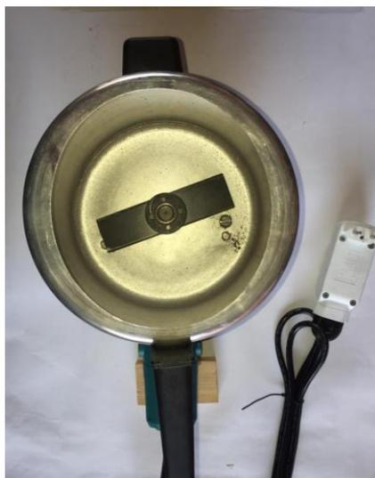
Com o novo elemento de corte acoplado a máquina, foi colocado os caroços de açaí dentro do vaso do equipamento e iniciou-se o processo de trituração com o
