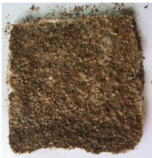
No experimento 2 também foi utilizado como molde uma caixa de papelão medindo 15,5cm X 15,5cm como molde coberta no interior com microfilme preparada para receber os materiais: uma camada de sementes trituradas e a resina acrílica a base de água. As sementes trituradas foram pesadas em balança digital de 1g, que marcou 43,70 g de sementes trituradas e 49,30 g de resina. O teor de resina foi inferior
