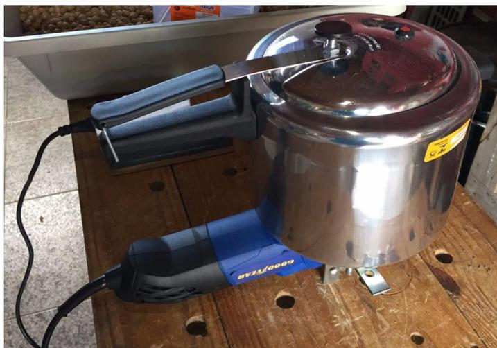
Este ajuste foi regulado pela permanência da máquina em funcionamento, inicialmente foi monitorado o tempo de um minuto. O tempo foi insuficiente para obter-se o tamanho das partículas pretendidas, início da trituração (Figura 48 a) e fim da trituração (Figura 48 b).
