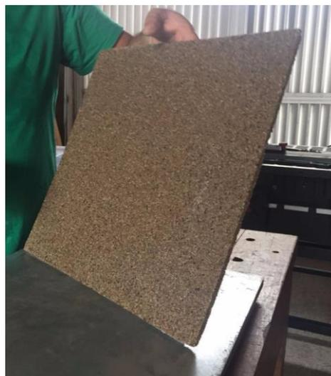
Ao se aferir as medidas do painel, observou-se uma perda de 5% (a espessura deveria ser de 10 mm) devido as sobras que ficaram no recipiente da mistura e nos objetos utilizados para a manipulação.
