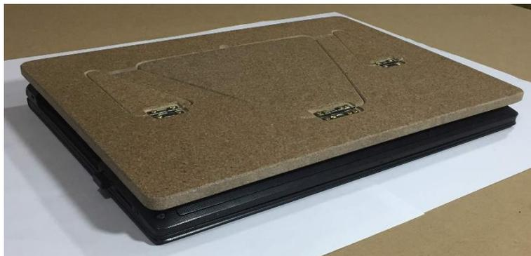
Uma vez realizado o acoplamento da máquina ao protótipo de suporte para *notebook* faz-se uma verificação se o subsistema de arrefecimento do *notebook* coincide com os rasgos abertos no interior do plano principal do objeto (Figura 117) que servem tanto para sediar os suportes de fixação de ângulo, assim como, para auxiliar o sistema de arrefecimento da máquina.
