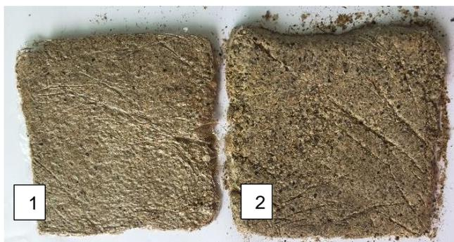
Diante destes resultados, concluímos que é necessário a realização de mais experimentos para determinar a quantidade adequada da relação entre as sementes e o teor de resina com a finalidade de obter-se um experimento sem fissuras com boa maleabilidade.
