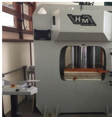
Ao término dos 10 minutos retirou-se o molde/bandeja metálica da prensa hidráulica e em seguida removeu-se o painel pronto do molde/bandeja metálica (Figura 67). Após os processos, obteve-se uma placa de 40X40 cm (figura 68), com espessura de 9,5 mm.
