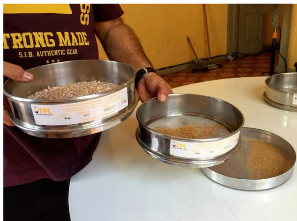
A pesagem do material obtido no peneiramento foi feita em balança de precisão da marca, *Notebook Series Digital Escala 2.000X0.1g*, depois sendo acondicionado em saco de papel pardo (celulose), em uma quantidade de 2 sacos de 1.300 g cada um (Figura 39). O material foi encaminhado para a fase seguinte: produção do compósito e de dois experimentos denominados 1 e 2.
