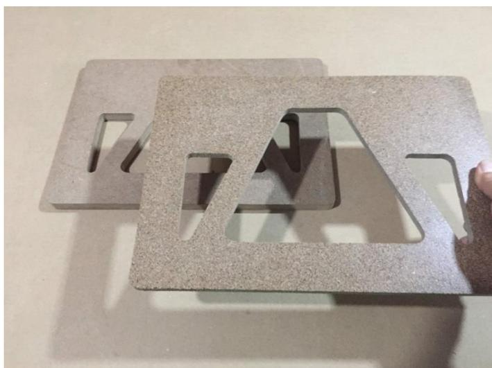
Em seguida passa-se para o início do processo de acabamento no sistema e nos subsistemas do protótipo, com a realização de cortes chanfrado com fresa em 45° em toda a extensão da face de topo e face dos cortes internos no plano principal, assim como, na face de topo de seus subsistemas, tarefa realizada em tupa estacionária de bancada (Figura 110) finalizando o processo de acabamento nos componentes do protótipo de suporte para *notebook*, passa-se a montagem de seu conjunto.
