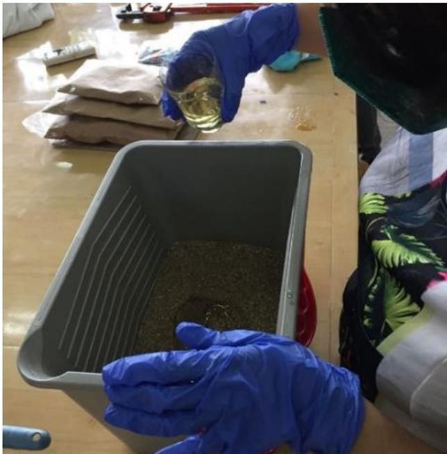
A homogeneização é gradativa e o processo inicia com a mistura do óleo de mamona com as partículas de corço de açaí, em seguida é adicionado o pré-polímero (Figura 61). Após 10 minutos de mistura, obteve-se uma massa homogênea pronta para ser moldada (Figura 62).
