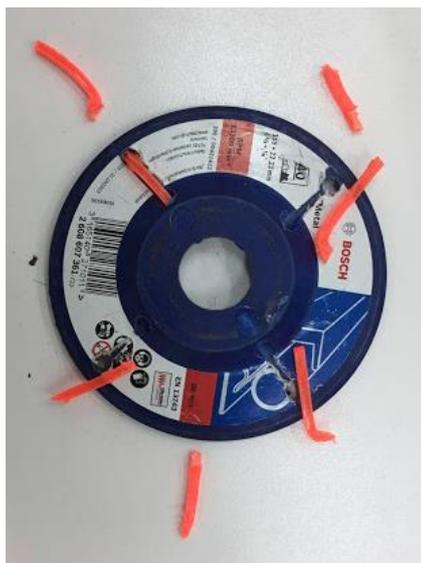
Com base no conhecimento empírico, foram substituídas as lâminas de fio de nylon por lâmina de aço temperado como elemento de corte (Figura 46).
