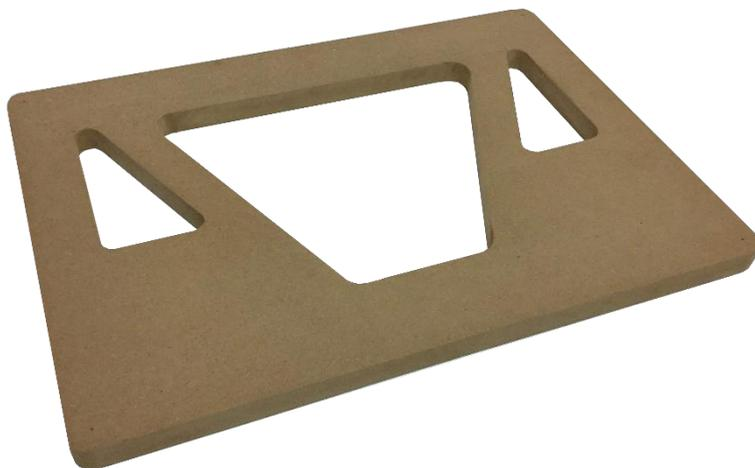
Com a elaboração do gabarito guia para corte com tupia laminadora, procedeu-se o teste de uso do instrumento (Figura 101) de maneira que este foi prendido contra uma chapa de papel prensado na espessura de 9,5mm (previamente marcada, furada e cortada) com auxílio de grampos tipo sargento apoiados em uma bancada para em seguida ser efetuado o procedimento de usinagem do material.
