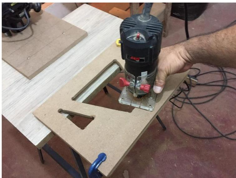
O resultando obtido nesse processo foi uma cópia fiel do gabarito guia para corte (Figura 102) comprovando assim, através deste teste a viabilidade de uso do gabarito na execução das tarefas de usinagem empregadas na construção do protótipo de suporte para *notebook* desenvolvido nesta pesquisa.
