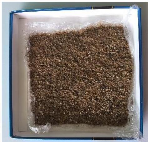
No experimento 2 não foi possível a retirada do microfilme na desmoldagem. Pois o mesmo aderiu ao experimento (Figura 54).
