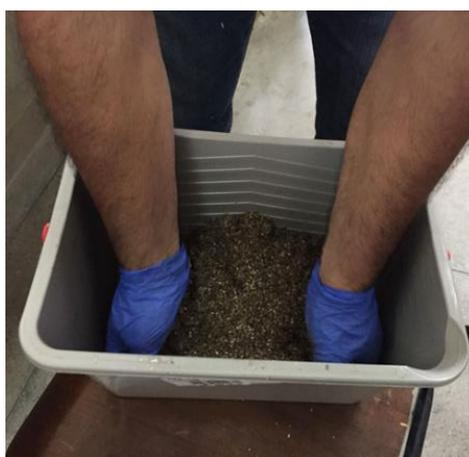
Após obter-se uma mistura homogênea, esta foi colocada em um molde de madeira que mede 40X40 cm, previamente é preparada uma bandeja metálica com desmoldante e revestida com uma folha antiaderente, delimitada por barras metálicas com dimensões de 10mmX10mm (Figura 63), em seguida, foi sobreposto o molde de
