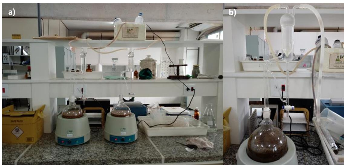
**Figura 18:** a) Extração de óleo essencial em nível de bancada; b) Clevenger.
