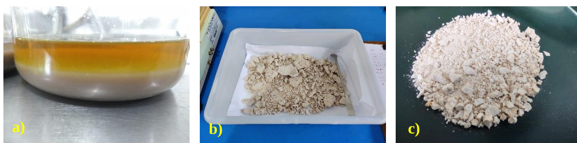
Figura 8: Polímeros de quitina heterogênea extraídos de escamas de pirarucu. A) desproteínização, b) quitina impura granulada, c) quitina purificada granulada. Imagens do autor.
