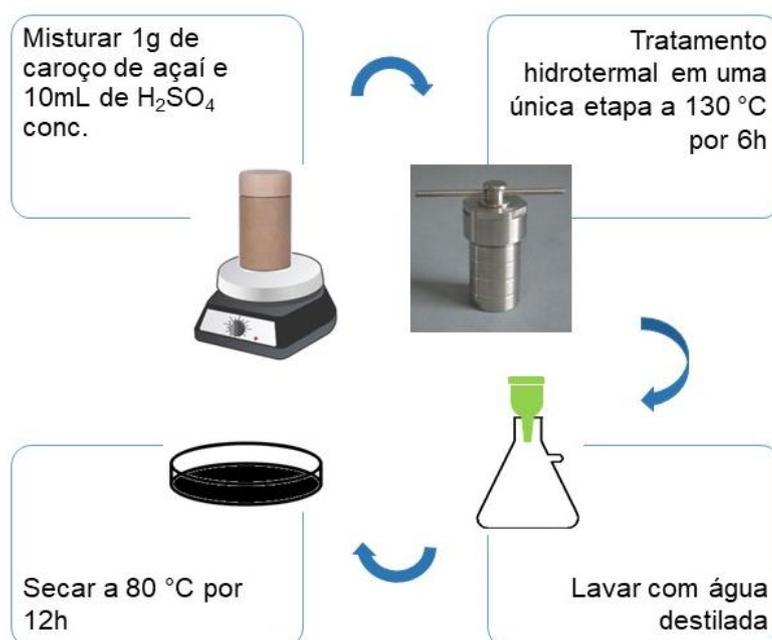
**Figura 3.2.** Esquema ilustrativo da síntese do catalisador (HTAS6-130) preparado no tempo de 6 h e na temperatura de carbonização e funcionalização hidrotermal em uma única etapa de 130 °C.
