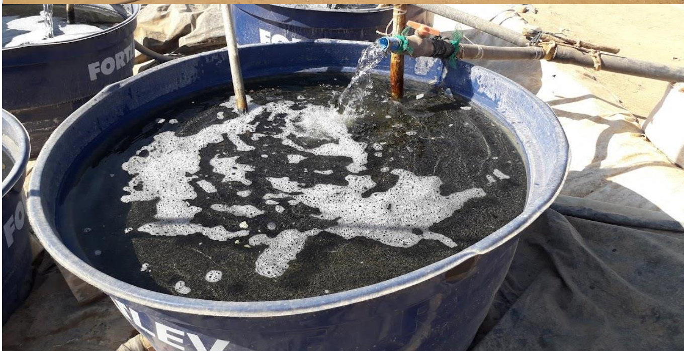
Figura 0:1: Processo de cianetação utilizado em Peixoto de Azevedo – Mato Grosso Fonte: O autor
