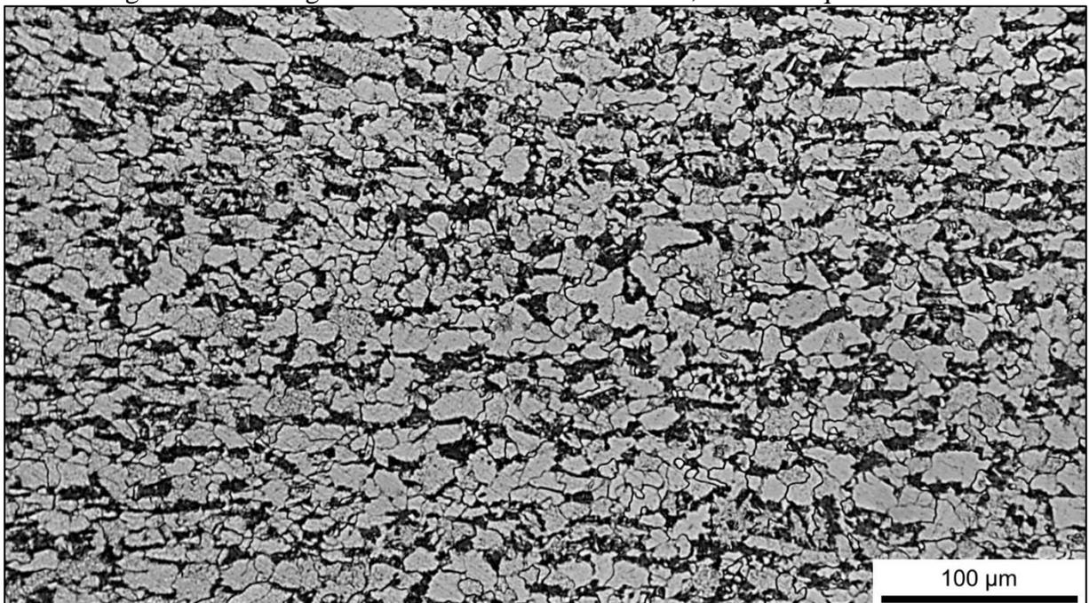
Figura 27 – Microestrutura do metal de base pelo MEV. Ataque Nital 2 %.
