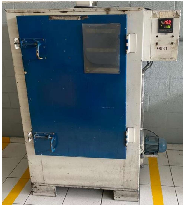
Figura 8 - Estufa utilizada para processamentos dos materiais.
