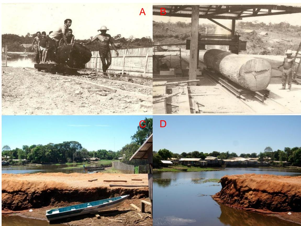
**A** - Quadrante D - retirada de toras de madeiras para serem usadas na serraria; **B** - Quadrante D – Processo de serragem das toras retiradas do Lago; **C e D** - Quadrante A – Lago sendo usado como depósito de resíduos de madeira.
