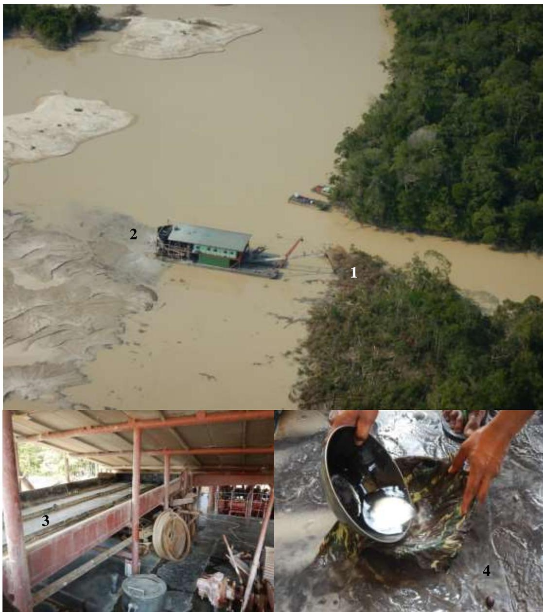
Figura 22. Processo de lavra aluvionar no rio Boia: 1- Dragagem do sedimento; 2 – Descarte do rejeito (assoreamento); 3 – Rampa carpetada; e 4 – Ouro amalgamado. Fonte: Marques (2020).
