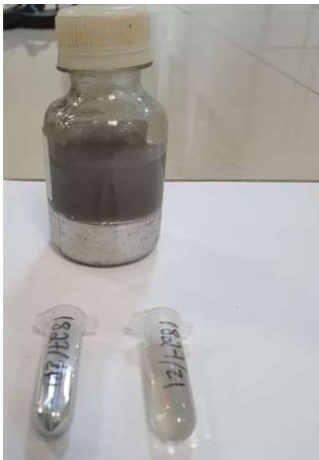
Figura 44. Amostra original de água de retorta, mostrando as duas fases presentes: mercúrio e água.
