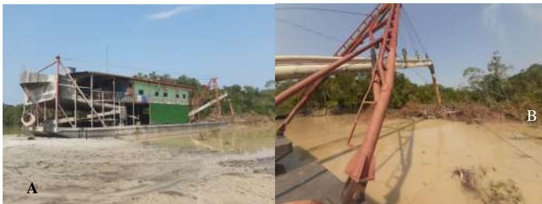
Figura 21. Balsa lavrando sedimentos na margem do rio na linha d'água. Assoreamento (A) e derrubada da vegetação para dentro do rio (B). Fonte: Marques (2020).
