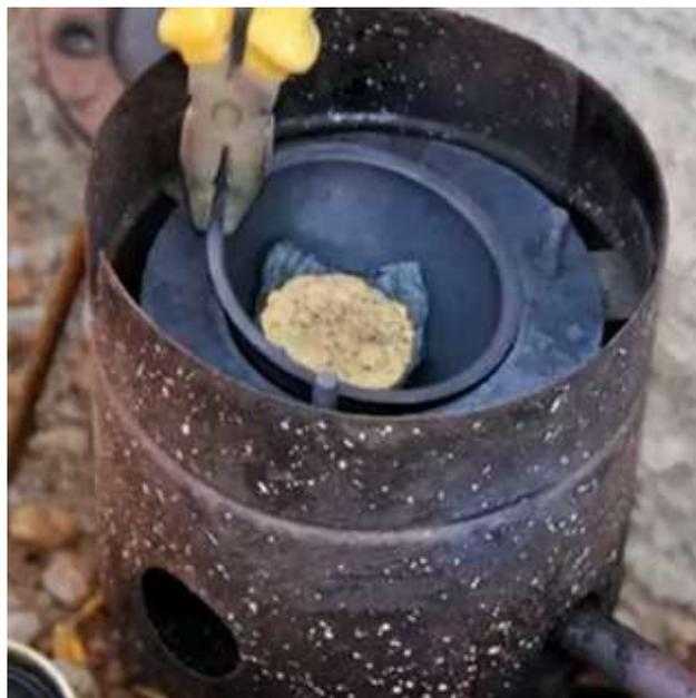
Figura 17. Ouro obtido no processo de “queima do amálgama”.
