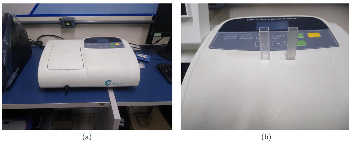
**Figura 4.16** - (a) Espectrofotômetro UV-Vísível modelo UV-6100 e (b) cubeta de quartzo. **Fonte:** Autoria própria.
