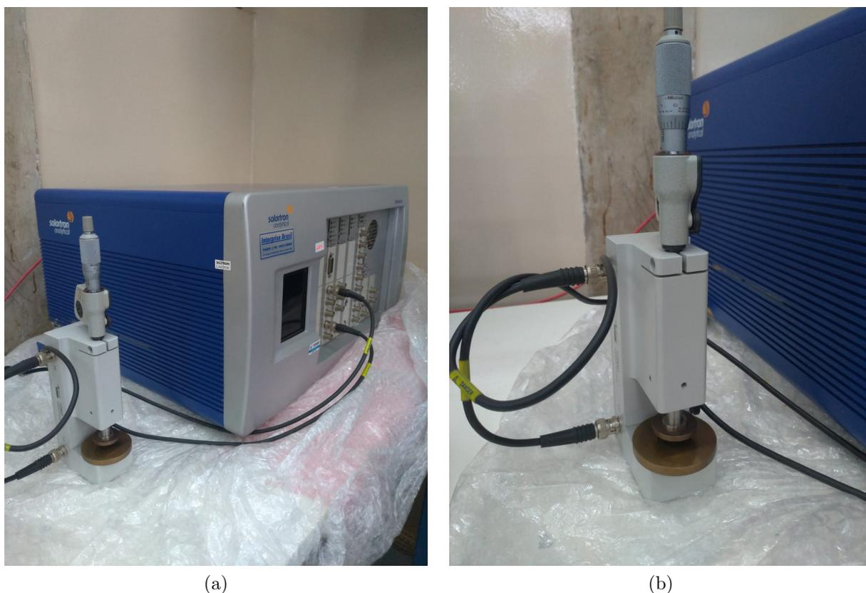
**Figura 4.13** - Em a) Equipamento usado para medir a impedância elétrica, (b) Porta amostra usado.
