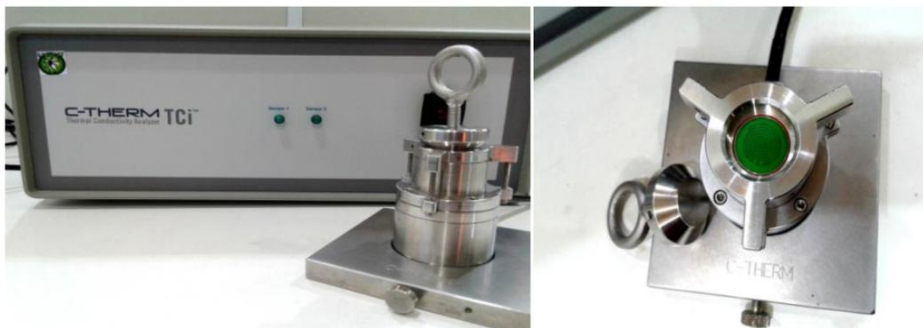
**Figura 4.11** - Equipamento TCI ao lado esquerdo e ao lado direito o sensor porta amostra. **Fonte:** LabMAT-UFAM.
