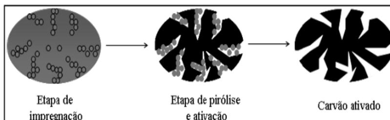
Figura 1 - Esquema representativo de como ocorre a ativação química. Fonte: Gregg; SING, 1982)
