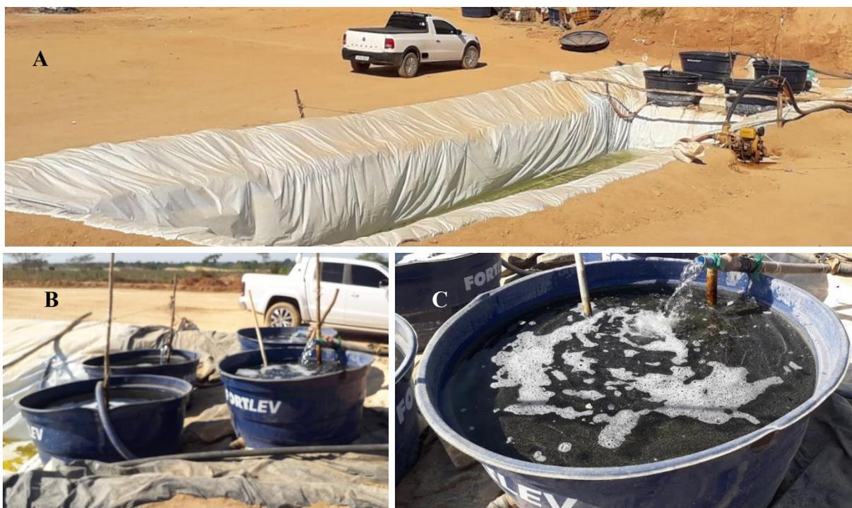
Figura 10 - Processo de cianetação utilizado em minas de extração de ouro em Peixoto de Azevedo – Mato Grosso. Fonte: Lima et. al (2022).
