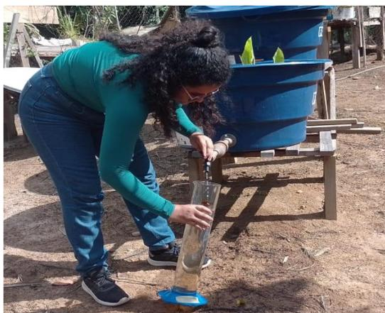
Figura 26 – Medição da vazão dos sistemas *wetlands* construídos acoplado a filtro de carvão ativado
