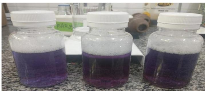
Figura 15 – Amostra de água com o substrato enzimático adicionado para determinação qualitativa de coliformes
