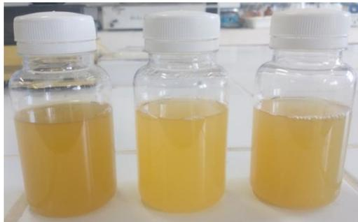
Figura 27 – Teste positivo para coliformes totais
