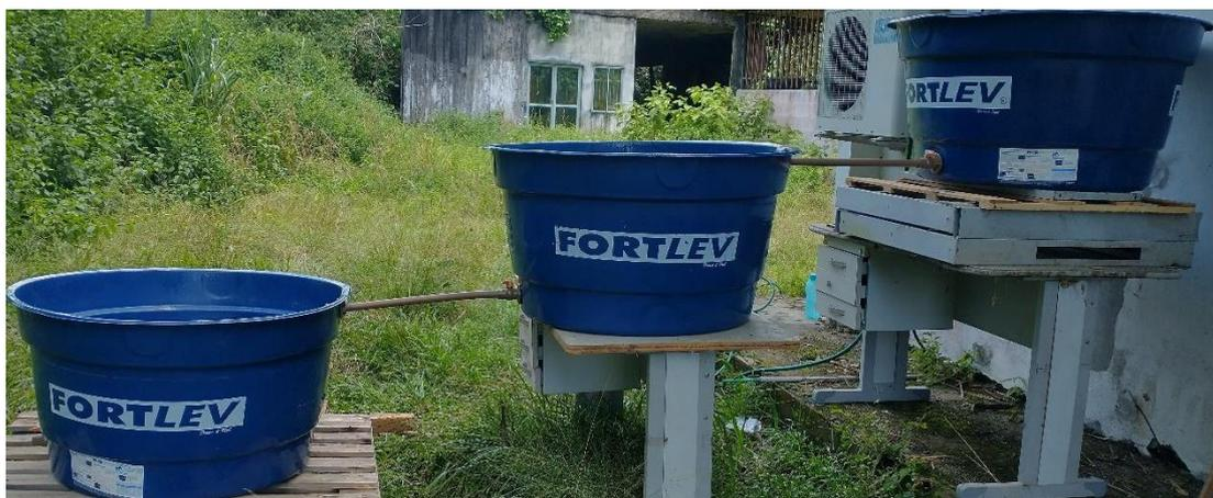
Figura 17 – Montagem do sistema *wetland* construído acoplado a um filtro de carvão ativado
