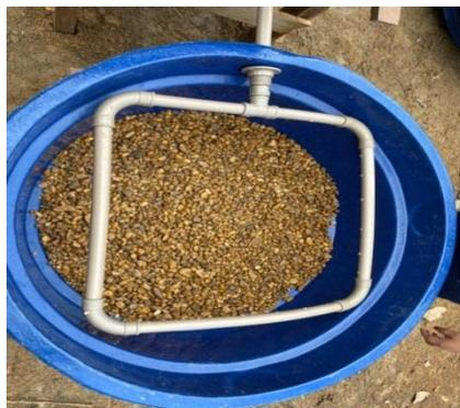
Figura 22 – Seixo como meio suporte 20 cm de espessura
