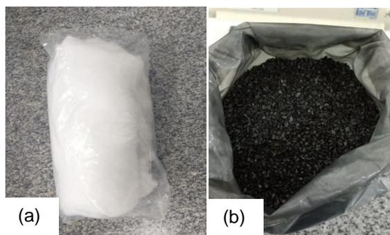
Figura 24 – Manta acrílica do tipo perlon (a) e carvão ativado granular da casca de coco (b)
