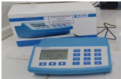
Figura 16 - Fotômetro HI83300
