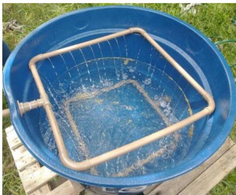
Figura 18 – Tubulação perforada para melhor distribuição de água
