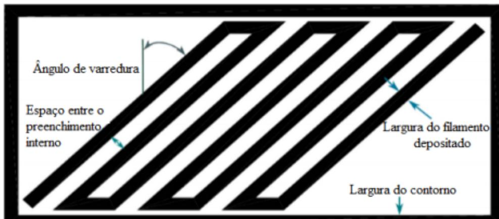
Figura 6 - Parâmetros de um processo de extrusão de material. Adaptado de ALAFAGHANI et al. (2017).
