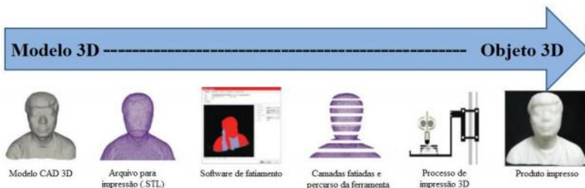
Figura 5 - Processo de impressão 3D. Adaptado (ZHANG; DONG; SADDIK, 2015).
