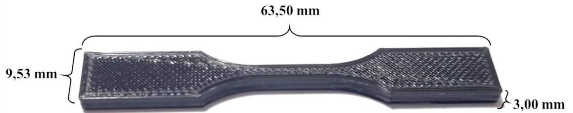
Figura 14 - Corpo de Prova produzido por manufatura aditiva para o ensaio de tração.
