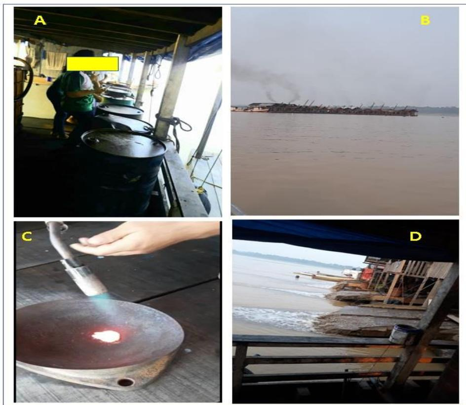
**Legenda:** [A]Barco com suprimentos para apoio as balsas; [B] Aglomeração de balsas “fofoca”. [C] Processo de retortagem da amálgama feito na balsa; [D] Bombeamento de detritos do rio
