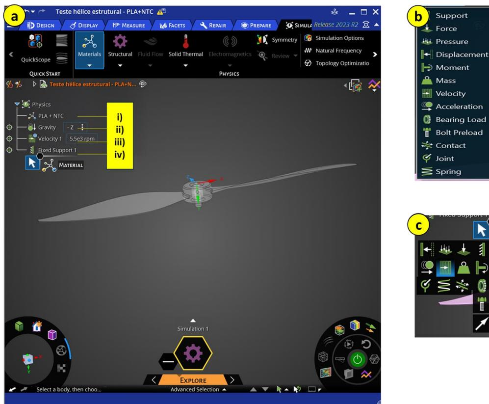
Figura 27-a) Interface Ansys discovery; b)Condições de contorno; c)Opção de aplicação de valores
