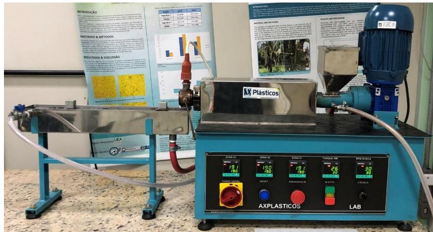
Figura 19 - Mini extrusora AX PLÁSTICOS
