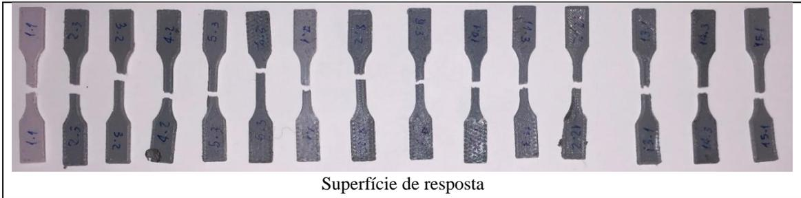
Figura 29 - CPs após o rompimento no ensaio de tração
