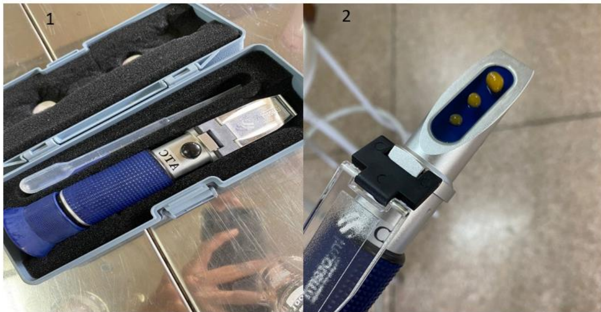
Figura 11- Análise de teor de sólidos solúveis totais por um refratômetro.
